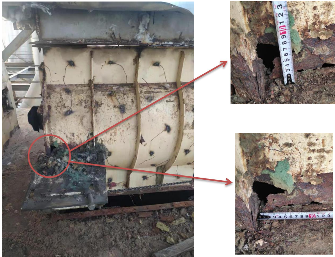
图6 干燥旋风除尘器锁气卸料阀腔体
